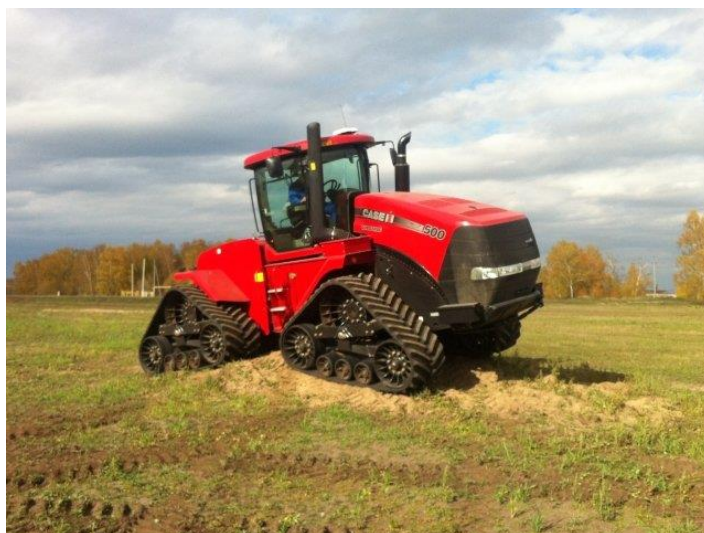
Рис.1. Трактор Case Quadtrack с ломающейся шарнирно-сочлененной рамой
