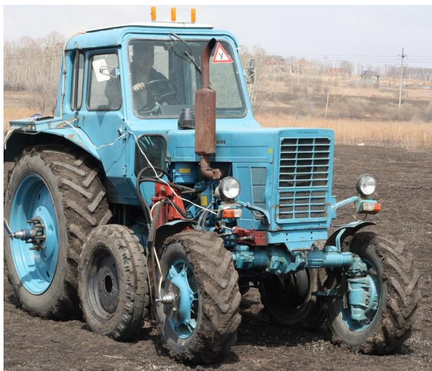
Рис.2. Колёсный трактор с дополнительным ведущим мостом на полевых работах
