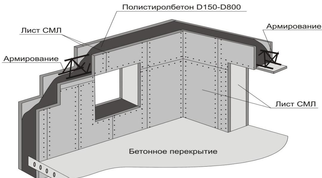
Рис.4. Устройство однослойных наружных стен из монолитного полистиролбетона
