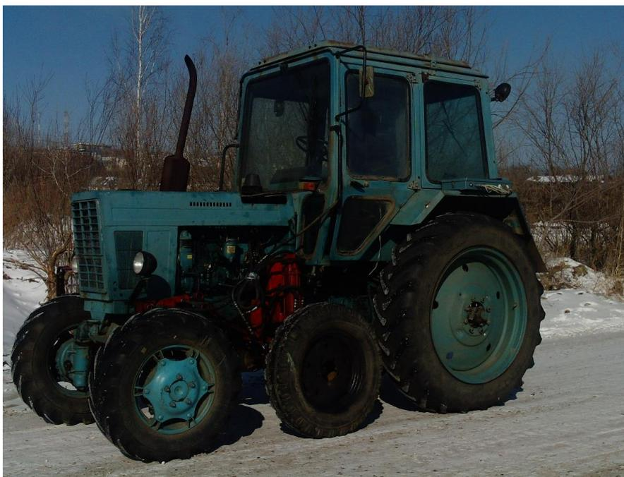
Рис.1. Колёсный трактор с дополнительным ведущим мостом на транспортных работах в зимний период эксплуатации
