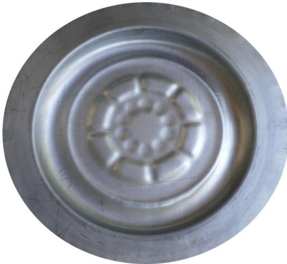
Рис.3. Деталь с мелким рельефом.
