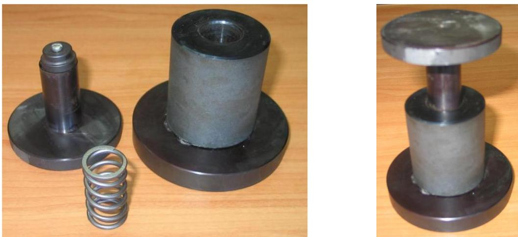
Рис.2. Устройство для заневоливания внутренней пружины клапана двигателя автомобилей семейства ВАЗ
