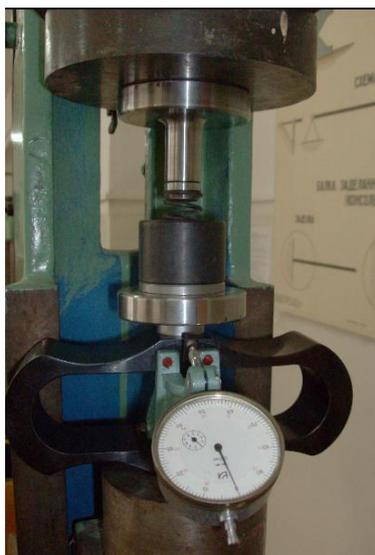
Рис.4. Устройство с пружиной и динамометром между захватами разрывной машины
