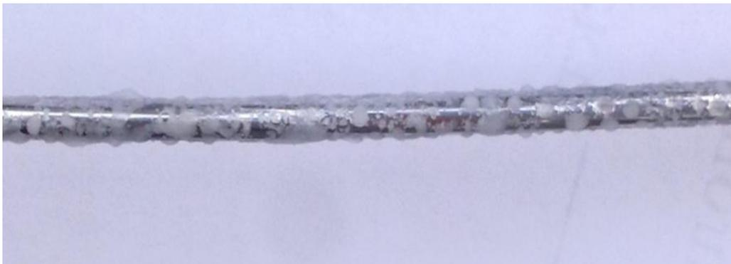
Рис.8. Наледь на поверхности алюминиевого провода
