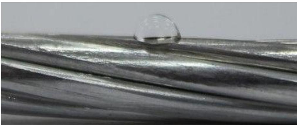
Рис.5. Капля воды на необработанной поверхности провода (6-кратное увеличение)
