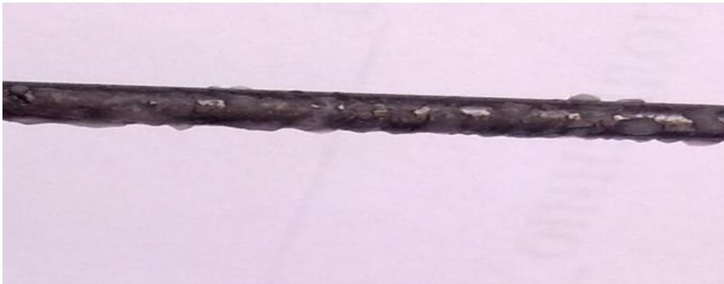
Рис.9. Наледь на поверхности графита
