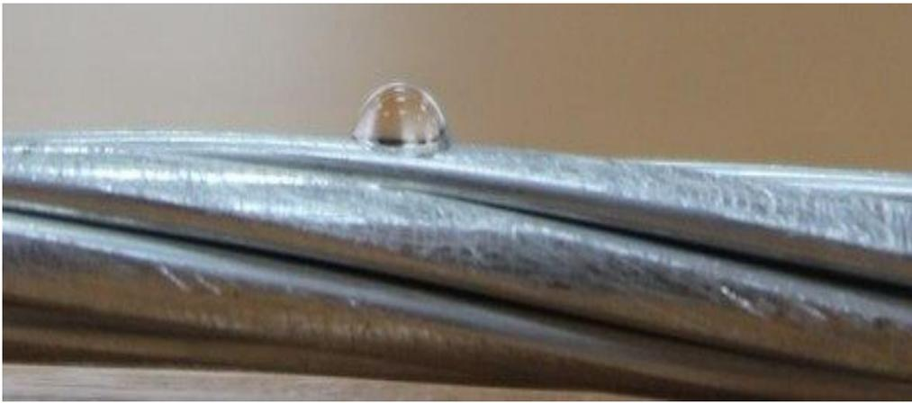
Рис.6. Капля воды на обработанной поверхности провода без графита (5-кратное увеличение)
