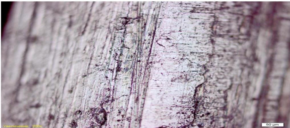
Рис.2. Поверхность алюминиевого провода в скрутке
