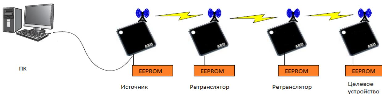
Рис.2. Последовательность режимов работы прикладного загрузчика.
