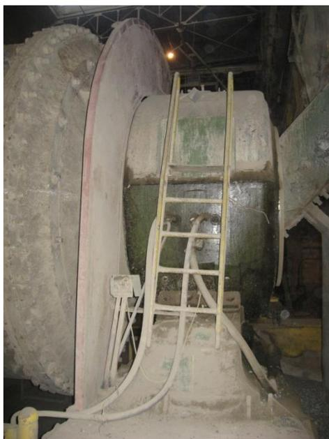
Рис.1. Опорный узел помольного агрегата
