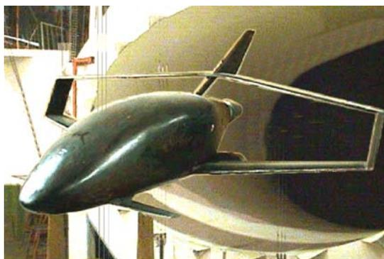
Рис.2. Модель самолета в АДТ ЦАГИ Т-103.
