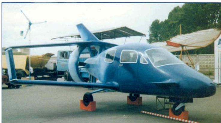
Рис.1. Полноразмерный цельнокомпозитный макет самолета Е-1.
