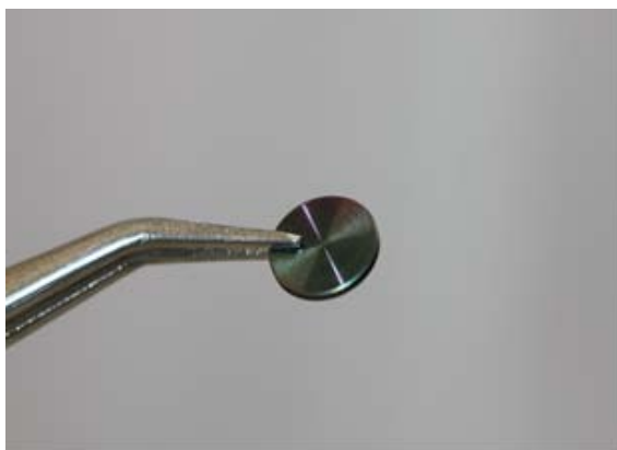
Рис.1 Образец сплава титана с электретным покрытием
