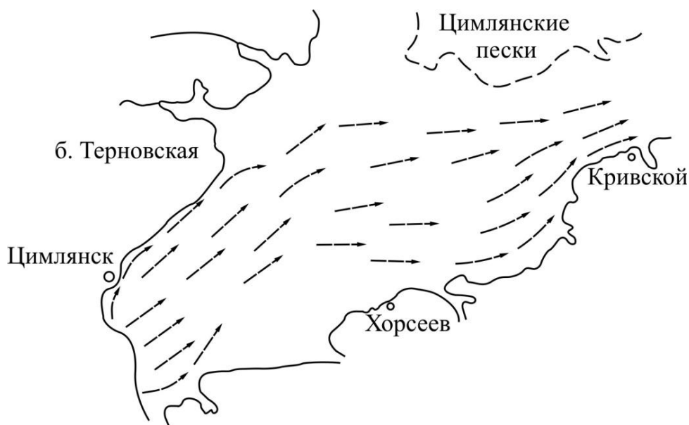
Рис.3. Схема компенсационных течений при восточных и северо-восточных ветрах
