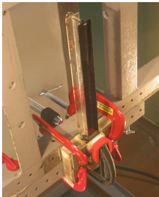
Рис.6. Крепление образца к испытательной установке
