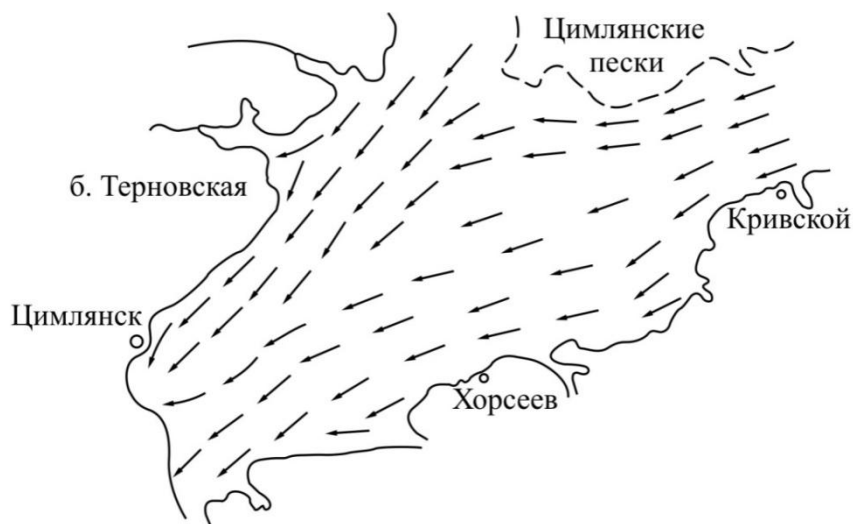
Рис.2. Схема ветровых течений при восточных и северо-восточных ветрах
