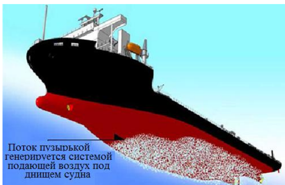
Рис.4. Принцип «воздушной смазки» подводной части корпуса корабля
