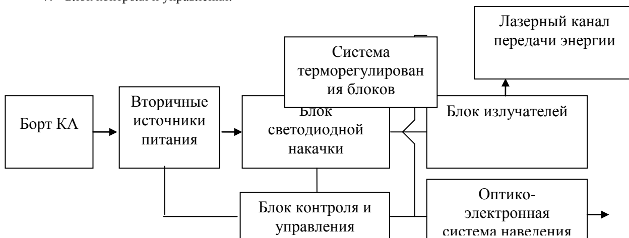
Рис.2. Структура блока лазерного излучателя
