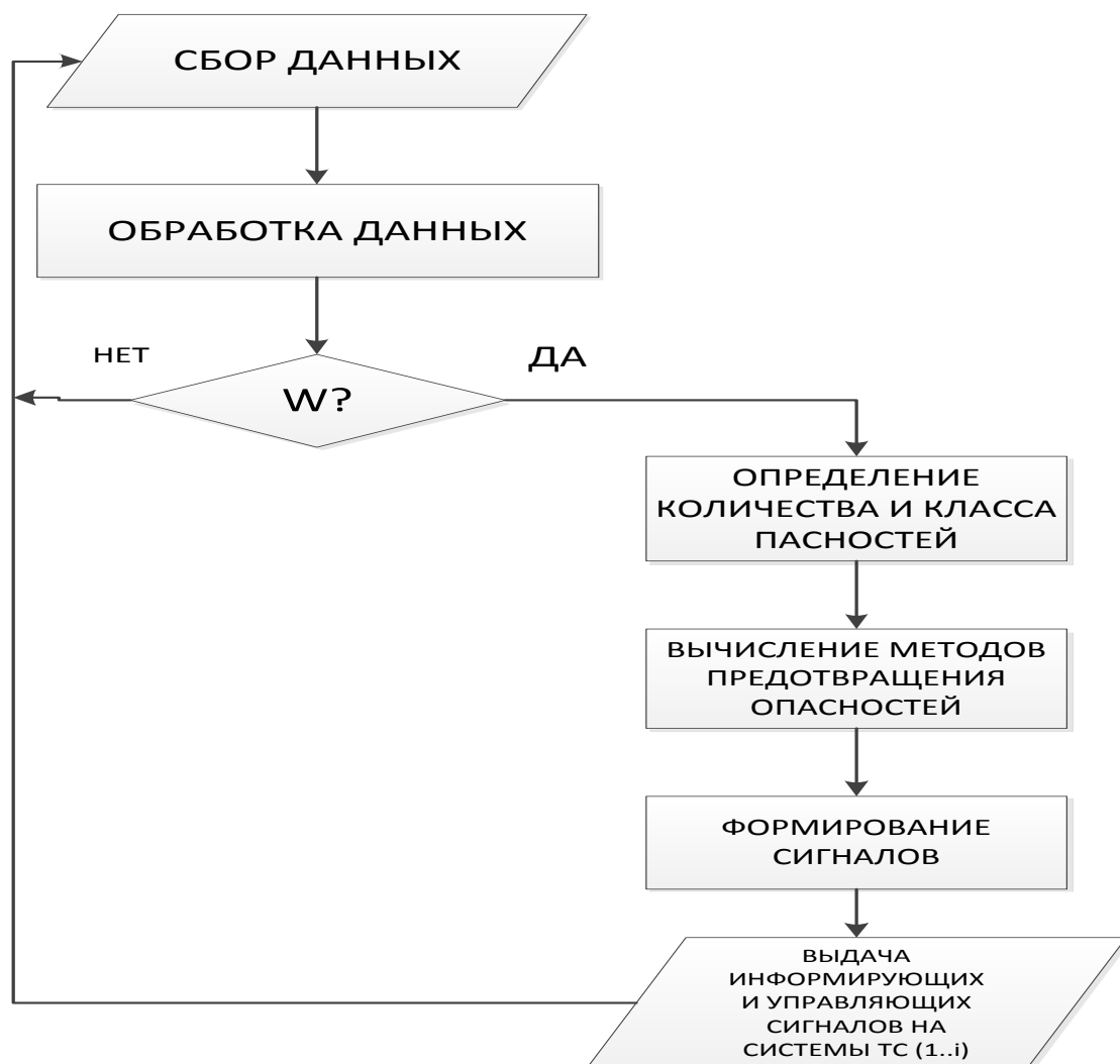
Рис.3 Общий алгоритм работы системы «Systemhelp»
