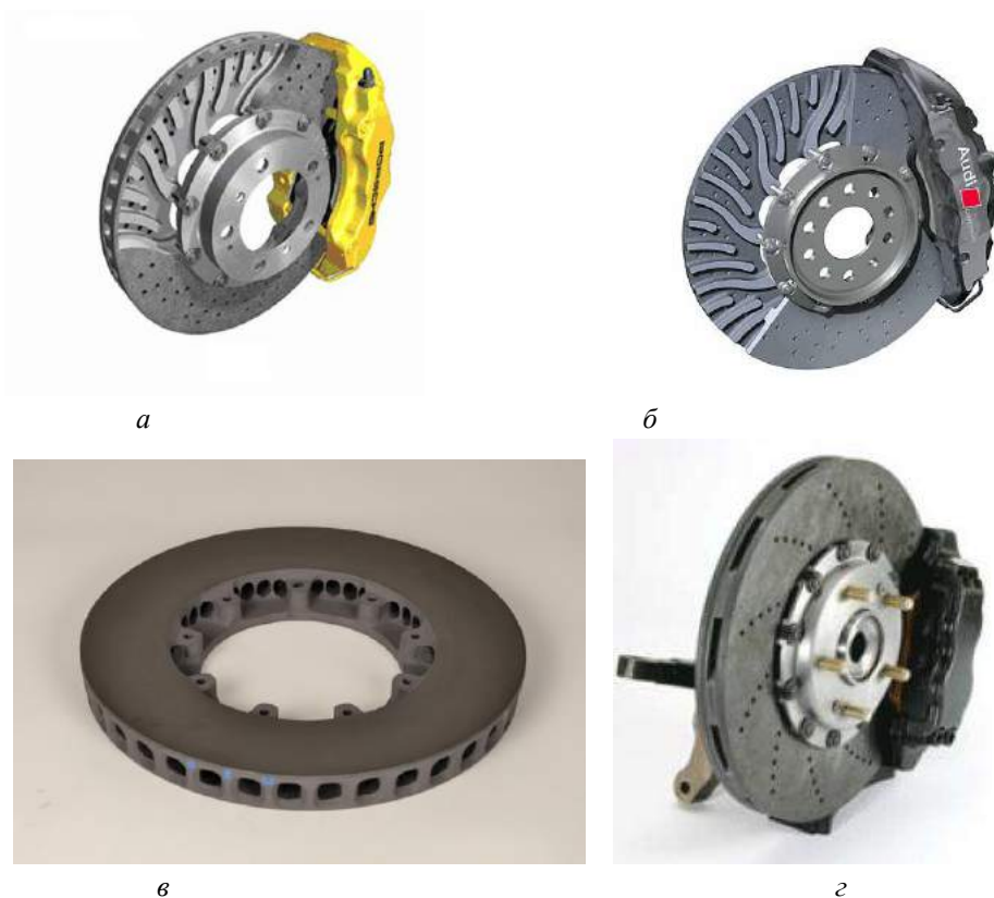
Рис. 2. Фотографии автомобильных тормозных дисков из КМК: вид в разрезе дисков фирмы SGL GmbH для Porsche 911 Turbo ( а ) [17] и фирмы Brembo для Audi R8 ( б ) [10]; в – фирмы MS Production для Ferrari F430 [12]; г – фирмы DACC [11]
