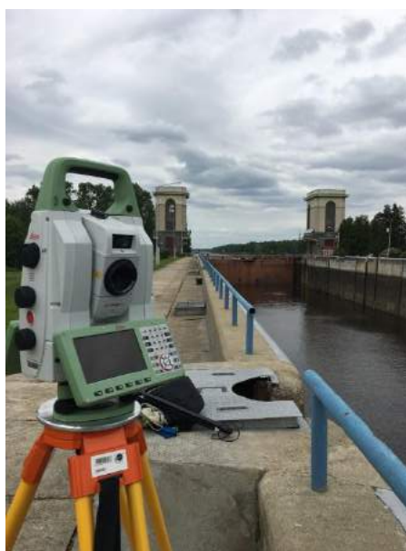
Рис.3. Электронный сканирующий тахеометр Leica MS60 в процессе съемки
