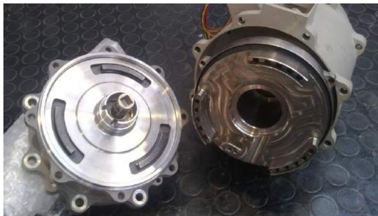
Рис. 7. Фотография тормозной системы на основе дисков из КМК для остановки вращающегося пропеллера и его надежной фиксации при обслуживании двигателя самолета А400М [14]
